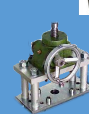
手动蜗轮蜗杆加载机构
